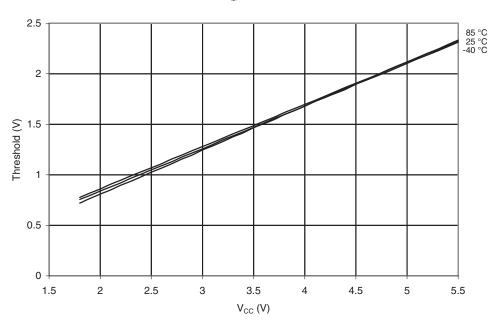
Figure 19-57.  $V_{\text{IH}}$ - $V_{\text{IL}}$ : Reset Input Pin Hysteresis vs.  $V_{\text{CC}}$
